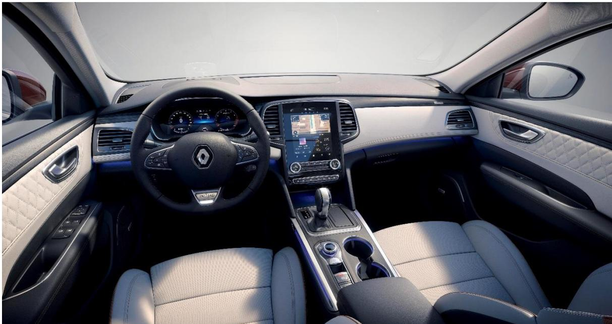
Als Instrumentenanzeige kommt neu ein individuell konfigurierbarer digitaler 10,2" TFT-Monitor zum Einsatz. Über MULTI-SENSE lässt sich die Anzeige personalisieren, unter anderem mit der Integration des Navigationssystems an idealer Position, direkt hinter dem Lenkrad.
