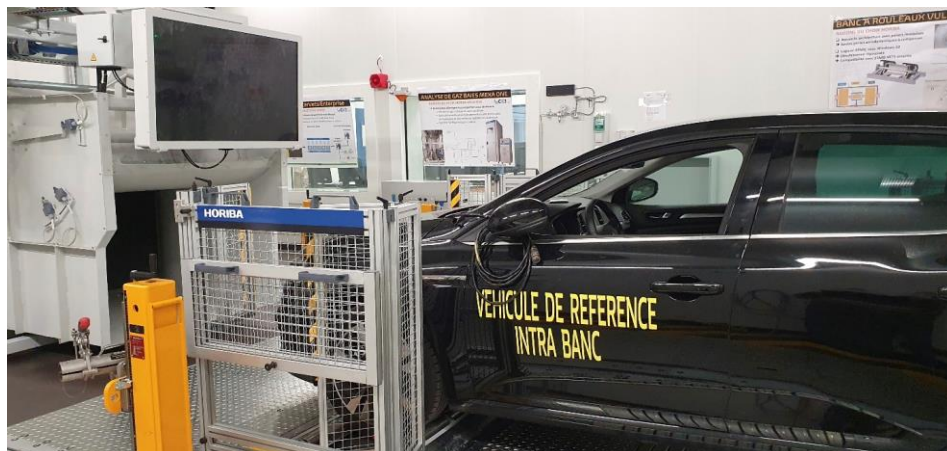
2020 – Mise en service d'un nouveau banc conso-autonomie climatique (-30 / +50C avec simulation du soleil)
