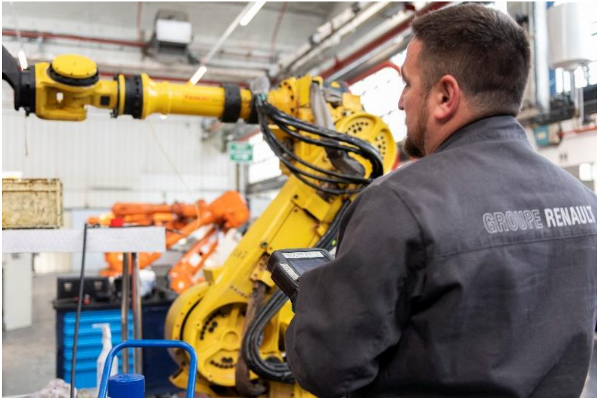
Aktivierung eines Roboters, um die Funktion seiner Achsen zu überprüfen
