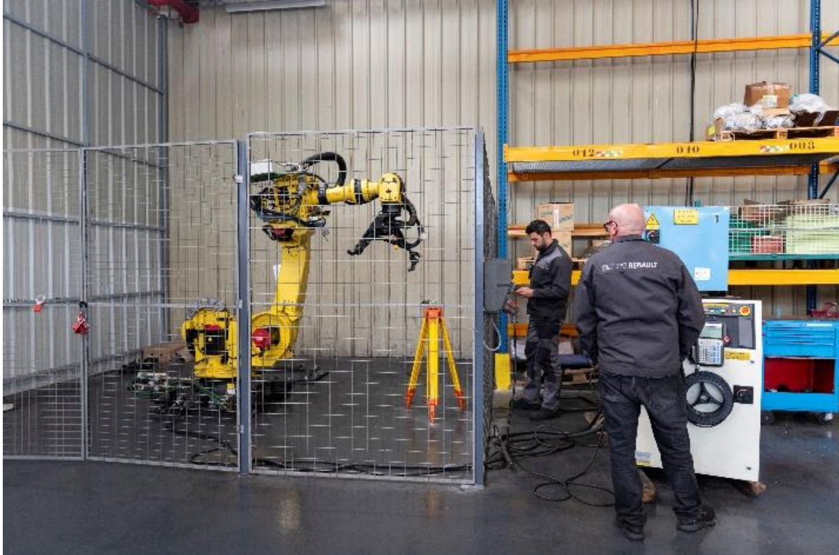
Automatische Zyklusvorbereitung zur Validierung der Wiederholbarkeit von Roboteraktionen
