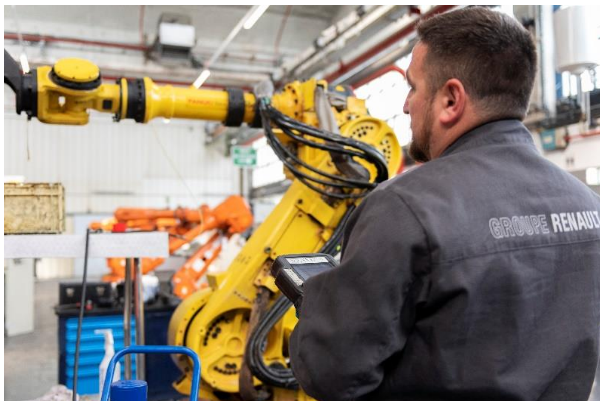
Activation d'un robot pour vérifier le fonctionnement de ses axes
