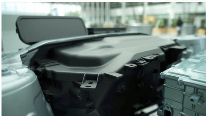
Pour y parvenir ils ont imaginé un nouveau système de fixation qui assure la tenue vibratoire et mécanique dudit bloc de chauffage et de climatisation sur le tablier qui isole l'habitacle du compartiment moteur.
