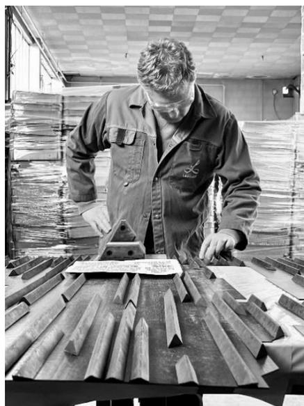
Pour respecter l'esthétique minérale des orgues basaltiques voulue par le design, les équipes de Lavoisier Composites ont fabriqué un plancher qui se compose d'une multitude d'éléments de section triangulaire dont les facettes révèlent la profondeur du carbone et
