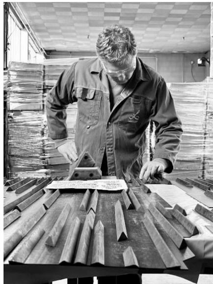
Um die von den Designern gewünschte mineralische Ästhetik des Basalteffekts zu erreichen, haben die Ingenieure von Lavoisier Composites einen Boden produziert, der aus einer Vielzahl von Elementen mit dreieckigem Querschnitt besteht. Deren Facetten legen die Tiefe des Carbons und den Glanz des Siliziums frei. Eine exklusive Kreation, die vollständig auf dem 3D-Modell basiert, das die Designer von Alpine entworfen haben.
