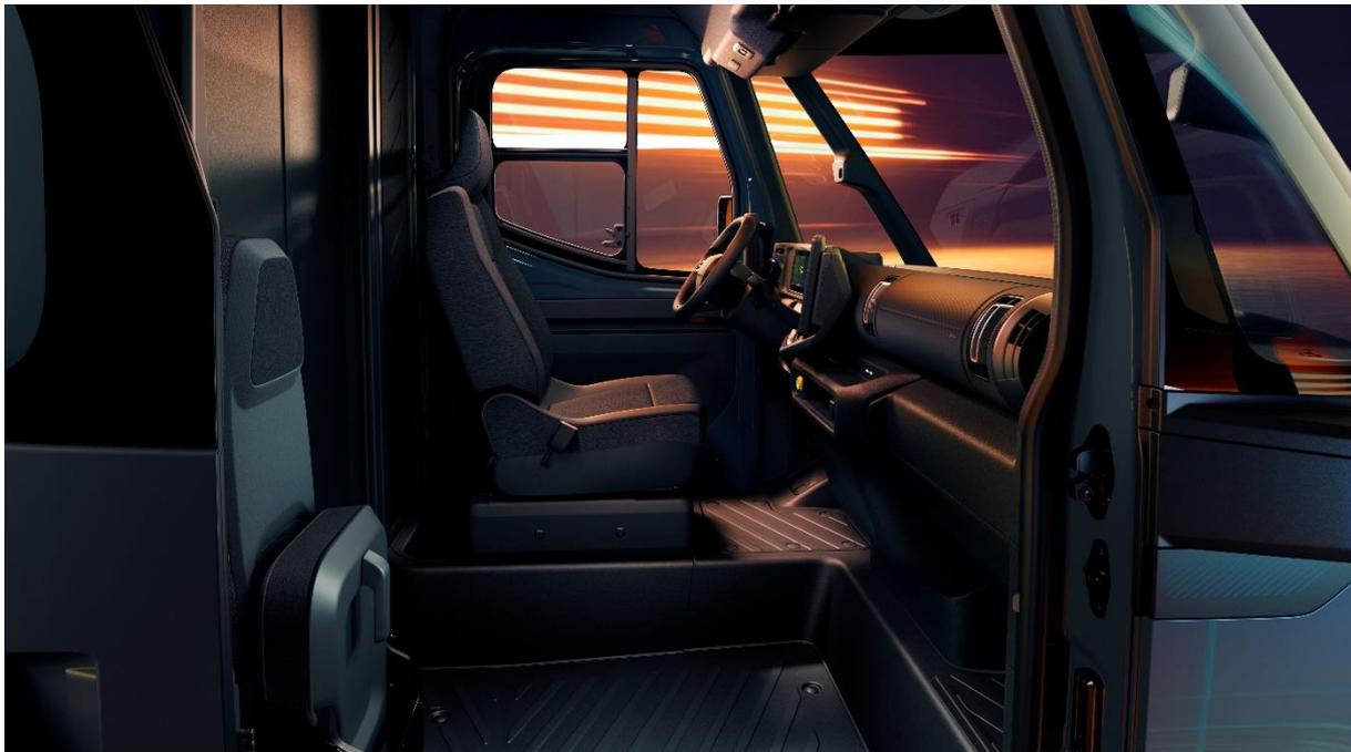
Der Fahrersitz befindet sich auf einem Podest, um eine gute Rundumsicht auf die Aussenumgebung zu ermöglichen und den Wechsel vom Lenkrad zum Laderaum zu erleichtern. Wenn der Fahrer anhält, um ein Paket auszuliefern, kann er per Knopfdruck automatisch die Innentür öffnen und die Warnblinkanlage einschalten.
